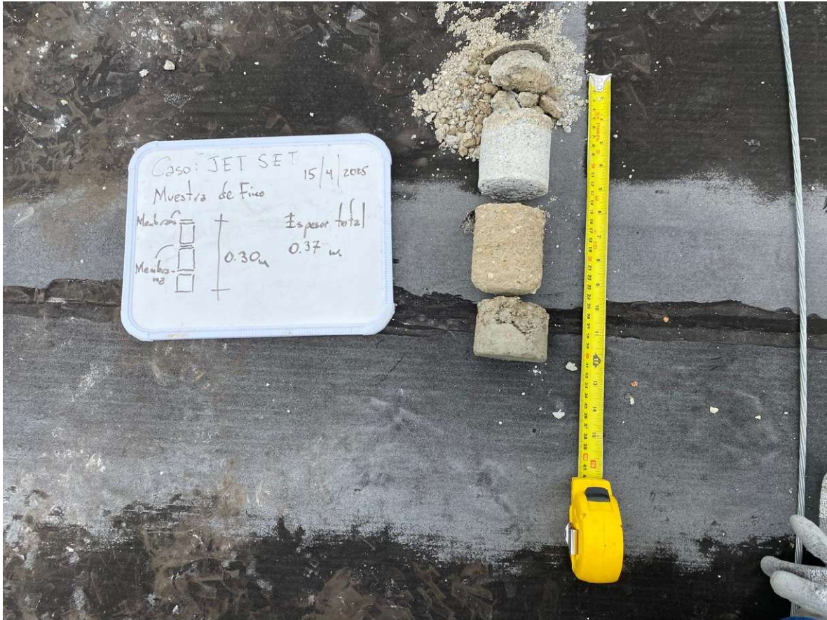
IMAGEN 13: FOTO DE LA MUESTRA DE LA EXTRACCIÓN DEL NÚCLEO DE FINO.
