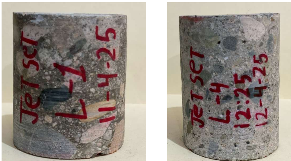
IMAGEN 33: TESTIGO LOSA L-1 Y L-4
